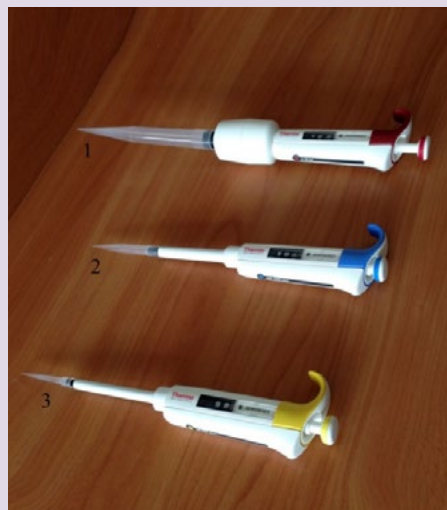
Рис. 7. Пипетки-дозаторы одноканальные переменного объёма: 1 — 1—10 мл; 2 — 100—1000 мкл; 3 — 10—100 мкл.
