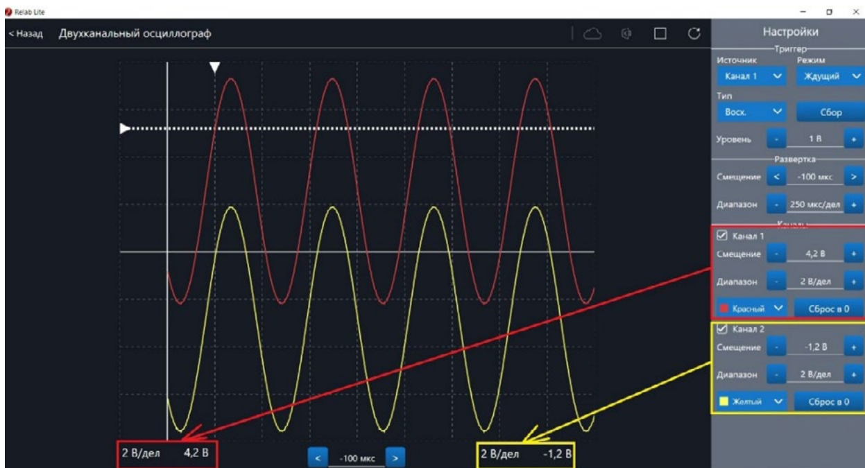
Рис. 39. Использование блока Каналы
