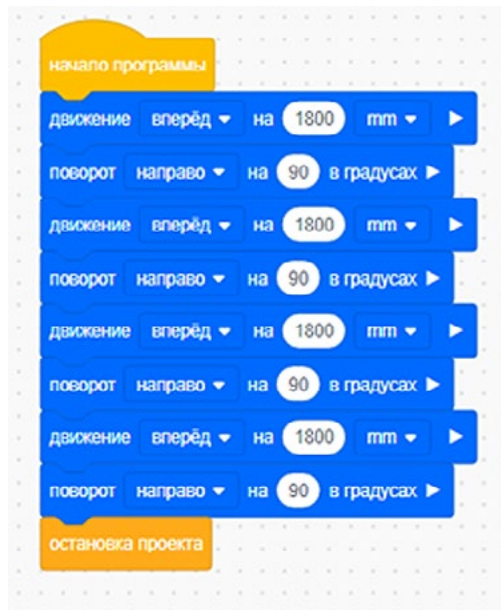
Рис. 8. Скрипт обхода VR-роботом игрового поля по периметру
