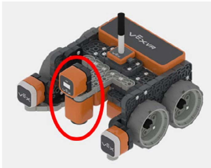
Рис. 30. Датчики цвета на VR-роботе
